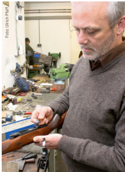
Der Meister mit einem umgebauten 98er mit Einsteckmagazin und Spezialabzug.
